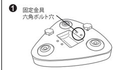
◎ 本体の固定金具六角ボルト穴の、丸で囲んでいる所に金具・カバーを取付けます。
